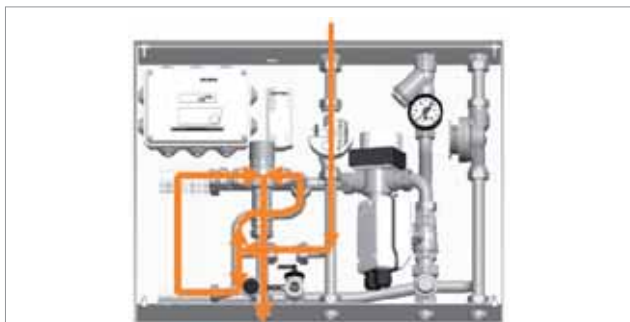
fig.10 Agua caliente sanitaria (ACS)
